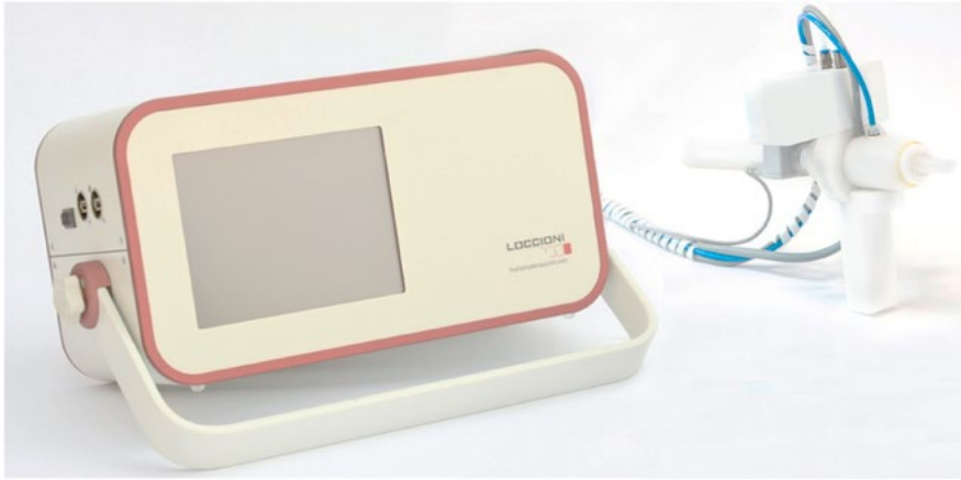
Prototyp eines tragbaren Atemgasdetektors, entwickelt an der ETH Zürich in Kollaboration mit der Firma Luccioni. (Bild: Andreas Güntner)
