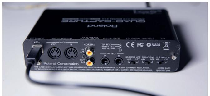
Schliesslich wird das Audiointerface per USB (Rückseite) mit dem USB-Hub verbunden.
