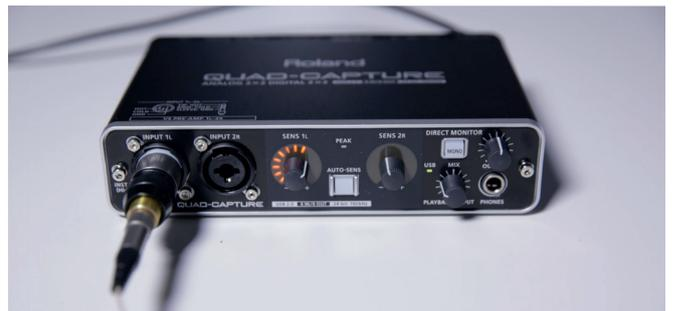
Beim Audiointerface wird auf der Vorderseite der schwarze XLR-Stecker des Mikrofons beim Eingang «INPUT 1L» eingesteckt.
