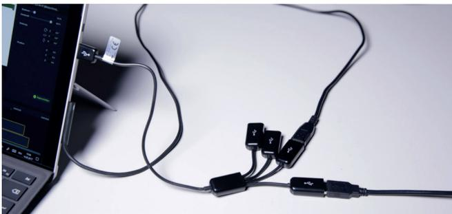
Der USB-Hub wird mit dem Surface verbunden. An diesen werden das graue Eingabegerät und das Audiointerface angeschlossen. Anschliessend kann das Surface gestartet werden.
