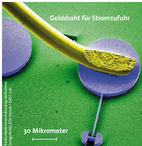
30 tausendstel Millimeter klein sind die zwei Kondensatoren mit Spule (unten), das Herzstück des ETH-Mikrolasers.
