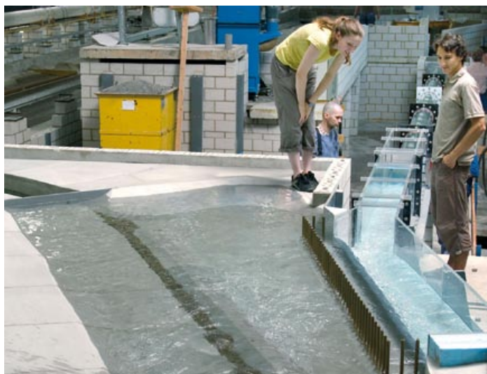
Das Einlaufbauwerk in den Lyssbach-Stollen im Modellversuch an der VAW.
