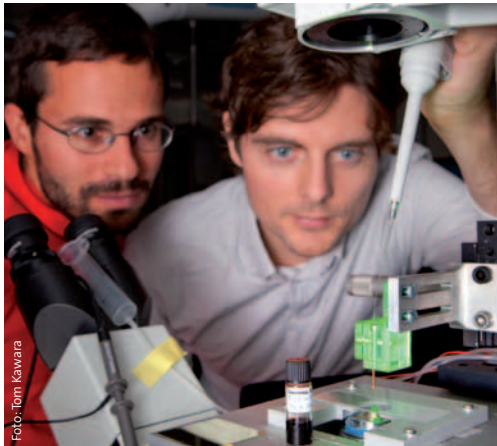
Die Doktoranden Julian Schneider und Patrick Galliker (rechts) beim Nachfüllen von Nanotinte an der Druckvorrichtung.
